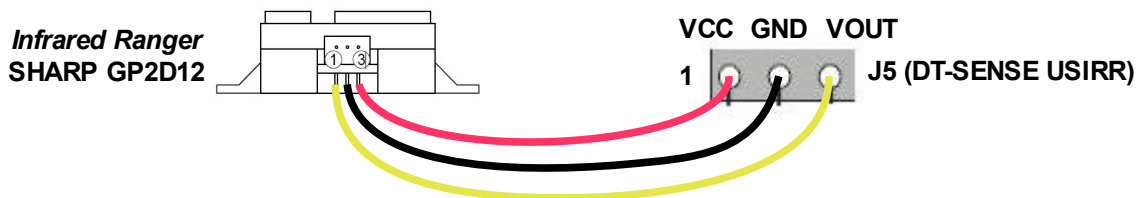
Gambar 11 Pemasangan Sensor Infrared 1
