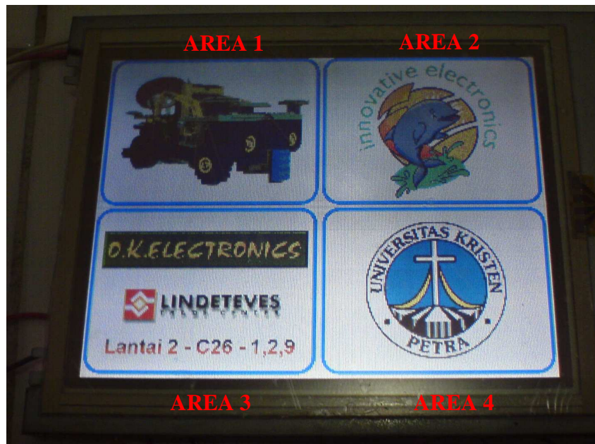
Gambar 6 Tampilan Menu Utama pada LCD
