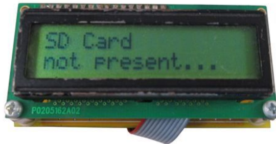
Gambar 5 Tampilan LCD jika SD Card tidak terdeteksi pada saat program pertama kali dieksekusi
