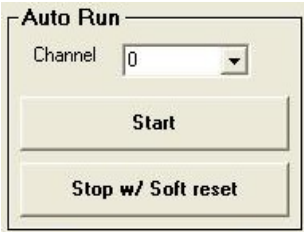
Gambar 11 Auto Run Digunakan Untuk Memutar Motor Stepper Secara Terus Menerus
