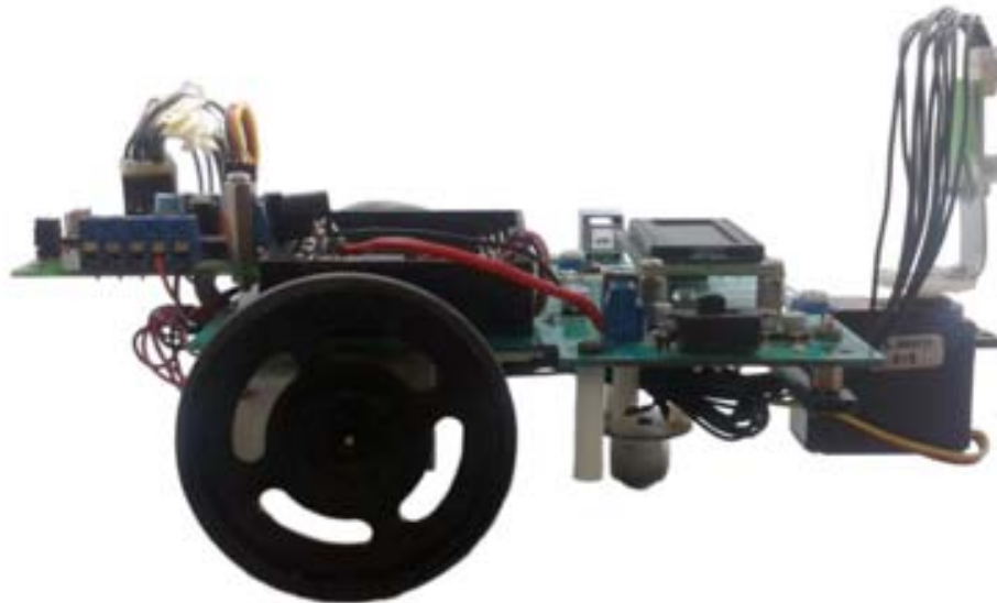
Gambar 3 Modifikasi DT-Robot Line Follower
