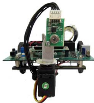
Gambar 5 Penempatan Thermopile Array Sensor Pada Motor Servo
