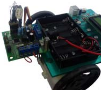
Gambar 4 Penempatan DT-Sense Thermopile Array Sensor pada DT-Robot Line Follower
