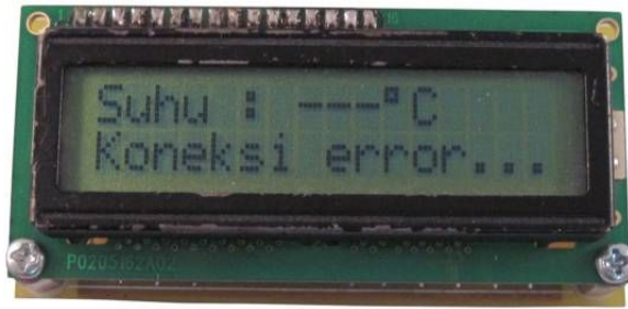
Gambar 11 Tampilan EMS LCD Display bila terdapat kegagalan penerimaan data
