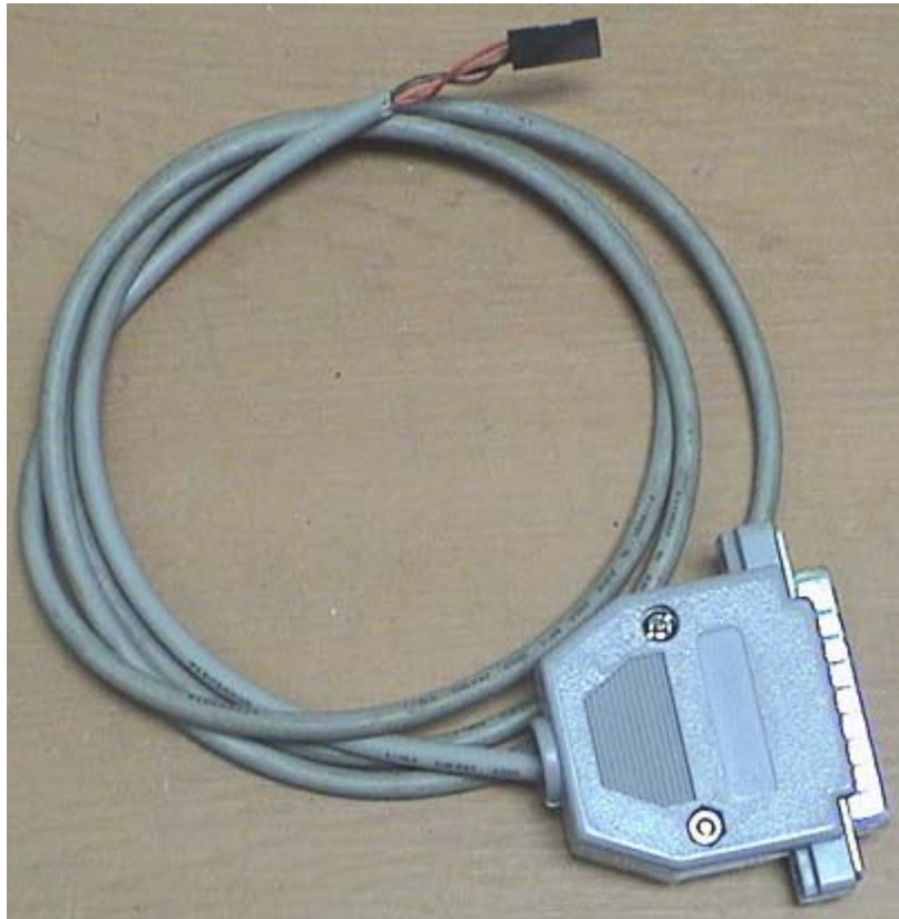
Gambar 2 Hasil Jadi Kabel SCC 1
